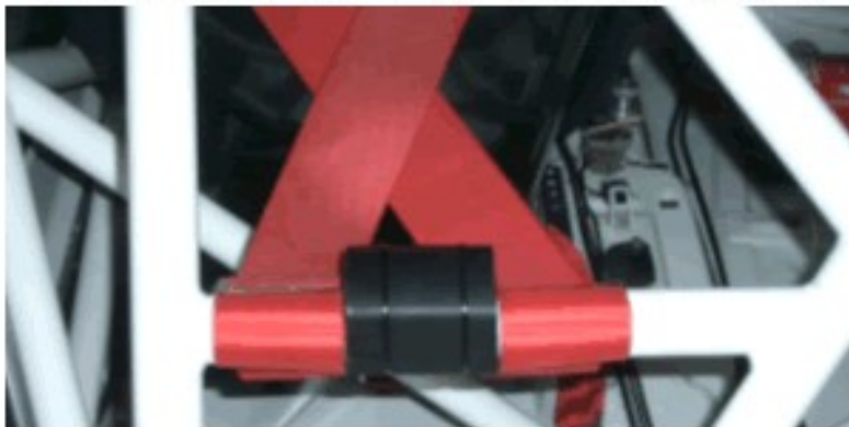
Beispiel eines Abstandshalters mit RA 88-57-2001 Polstermaterial
